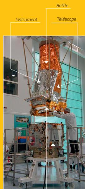
Intégration du satellite COROT : l'instrument est mis en place sur la plate-forme
